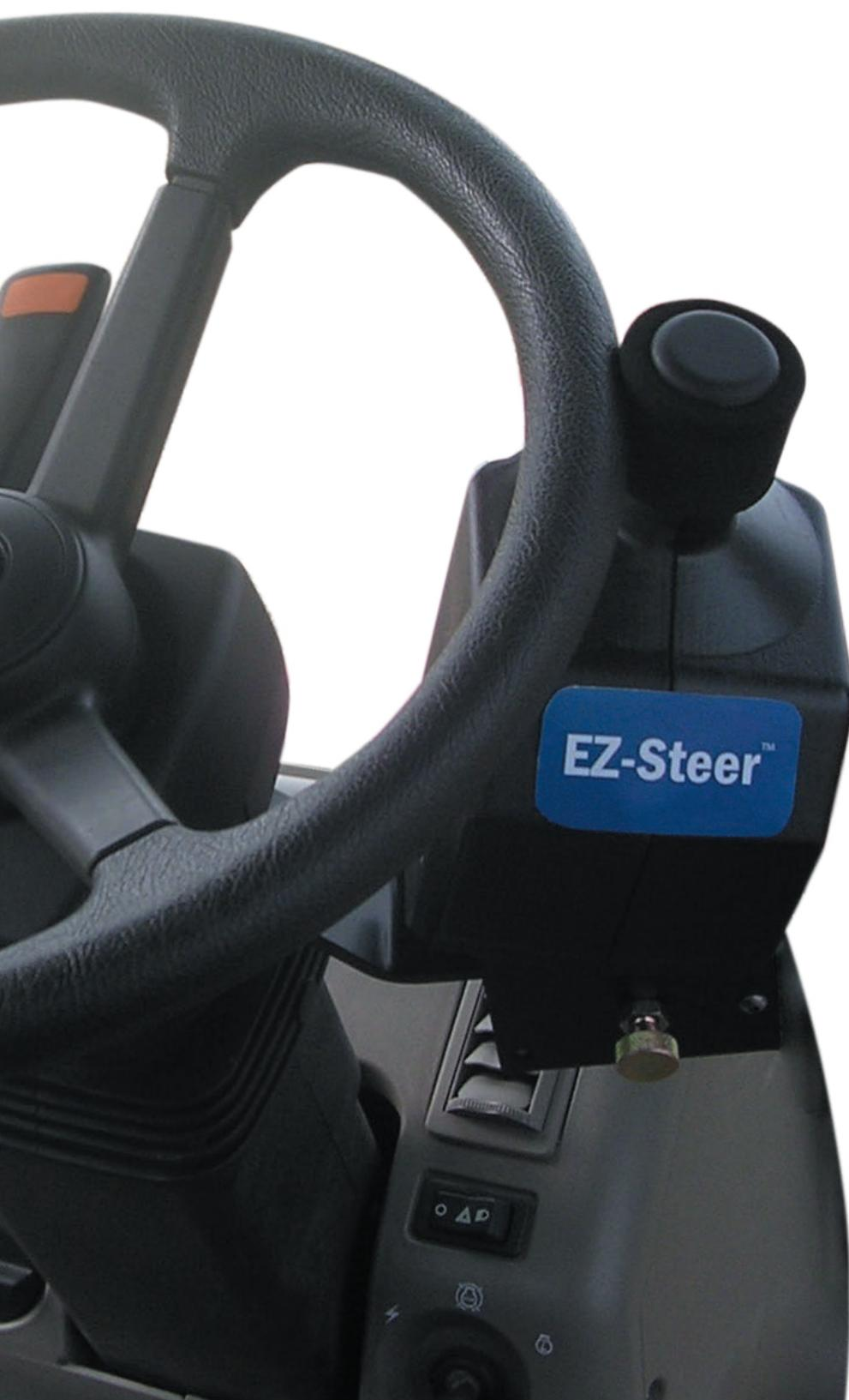
Le système EZ-Steer® tourne le volant pour vous en combinant un volant à friction et un moteur au guidage fourni par n'importe quelle console Trimble®.
